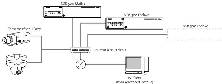
NB : Extension possible de la capacité d'enregistrement en cascadeant plusieurs NSR-500.
