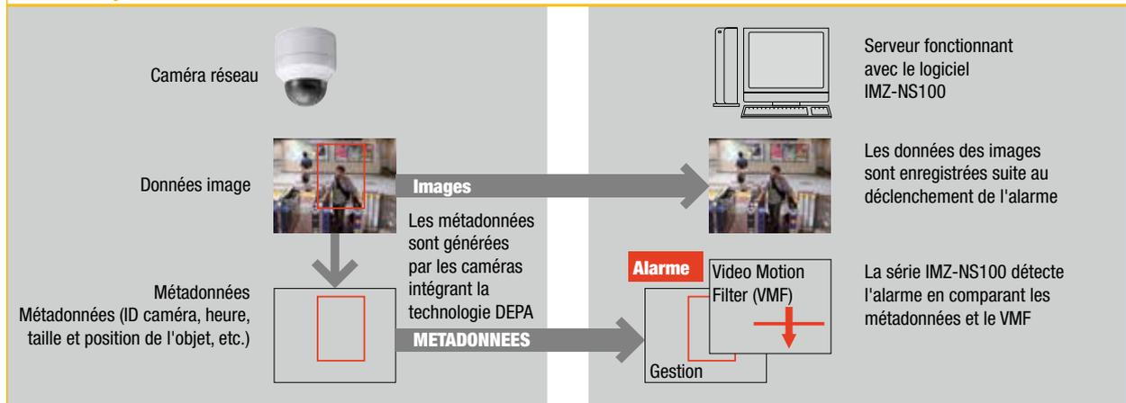
Une vaste gamme de filtres d'alarme prédéterminés sont disponibles, notamment : alarme anti-dérèglement de la caméra, frontière virtuelle, objets volés ou abandonnés, comptage d'objet, rémanence d'un objet dans une zone et analyse audio.
